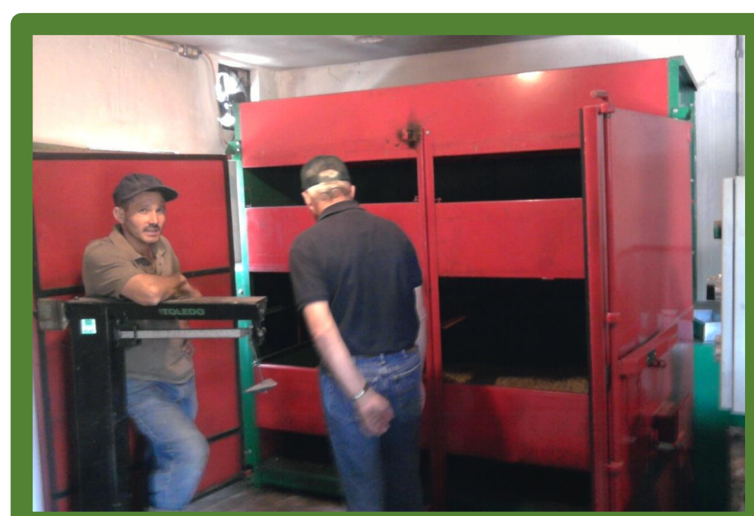
Horno de intercambio de calor con gavetas
