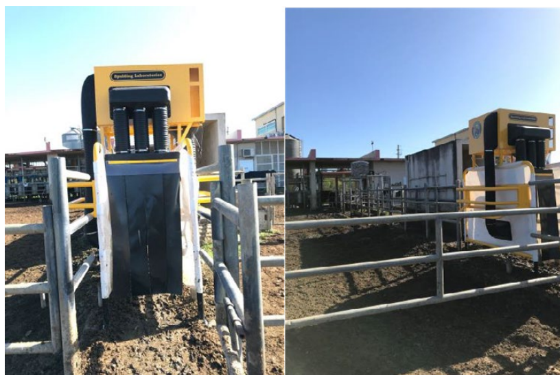
Máquina para atrapar moscas instalada en granja comercial de ganado lechero.
