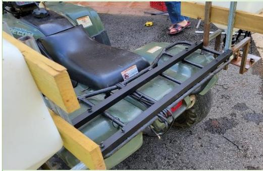
En esta parte podemos ver las piezas que juntan y aseguran los prototipos pintados utilizando una sola pieza por tubo para que sea más eficiente, segura, fácil de montar y cubra menos espacio.
