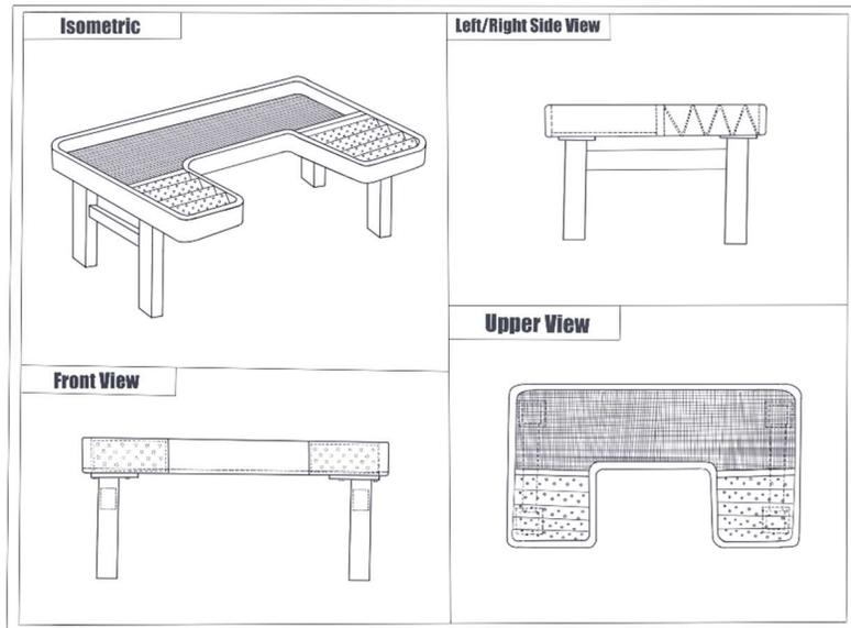
2. **Diseño 2:** El diseño de esta mesa se desarrolló para ser utilizado en un área de trabajo donde haya múltiples personas utilizando sillas de rueda. Este diseño facilita la unión de múltiples mesas utilizando un mecanismo de seguridad colocado en los lados de la mesa.
