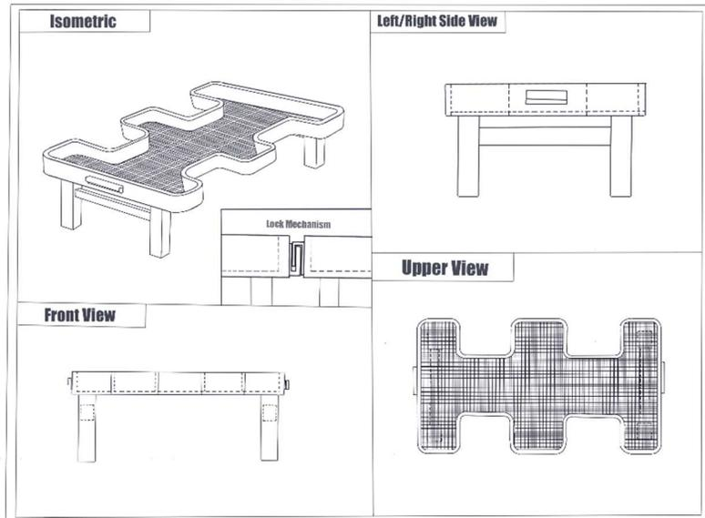
3. **Diseño 3:** El diseño de esta mesa se desarrolló como propuesta alterna para ajustar la altura de la mesa sin necesidad de un mecanismo eléctrico.
