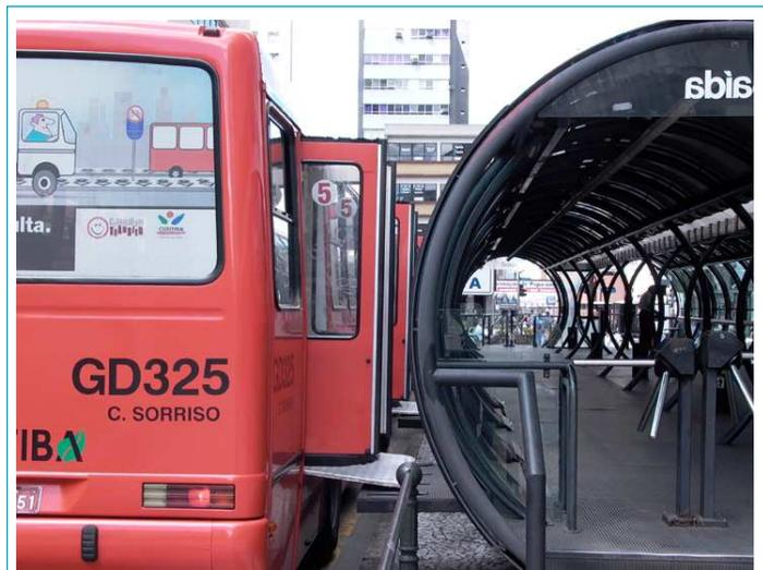
Un autobús biarticulado curitibano se detiene en una “estación tubo”. Las rampas se extienden para facilitar la entrada y salida de pasajeros.
