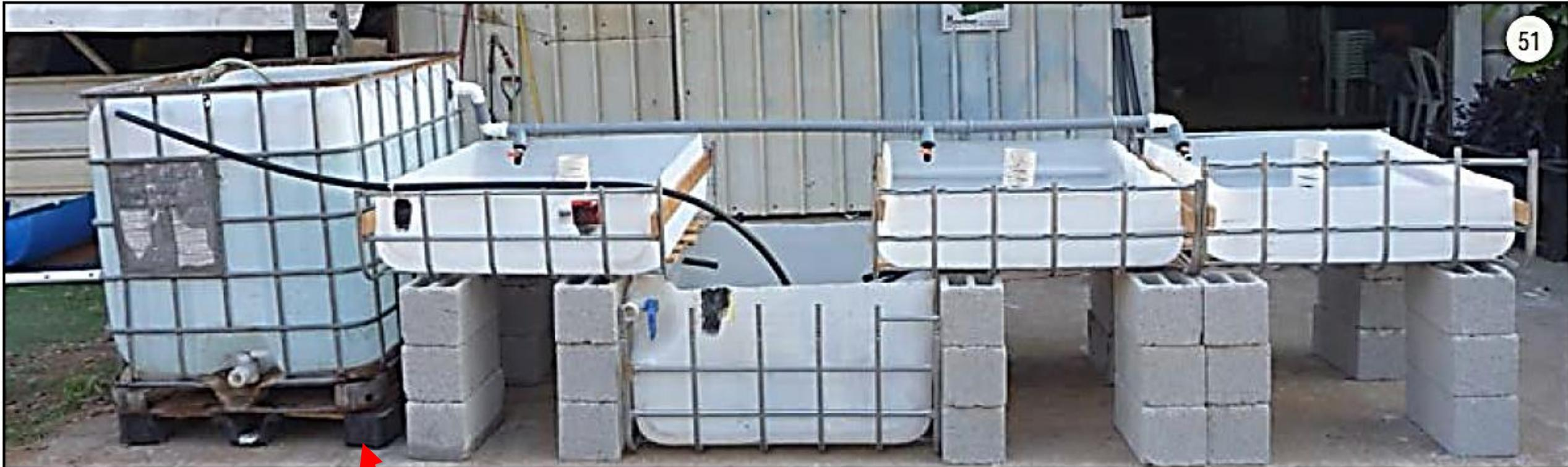
Noten que colocaron otra paleta (plástica) para aumentar la altura del tanque de engorde para facilitar la salida de agua por gravedad.
