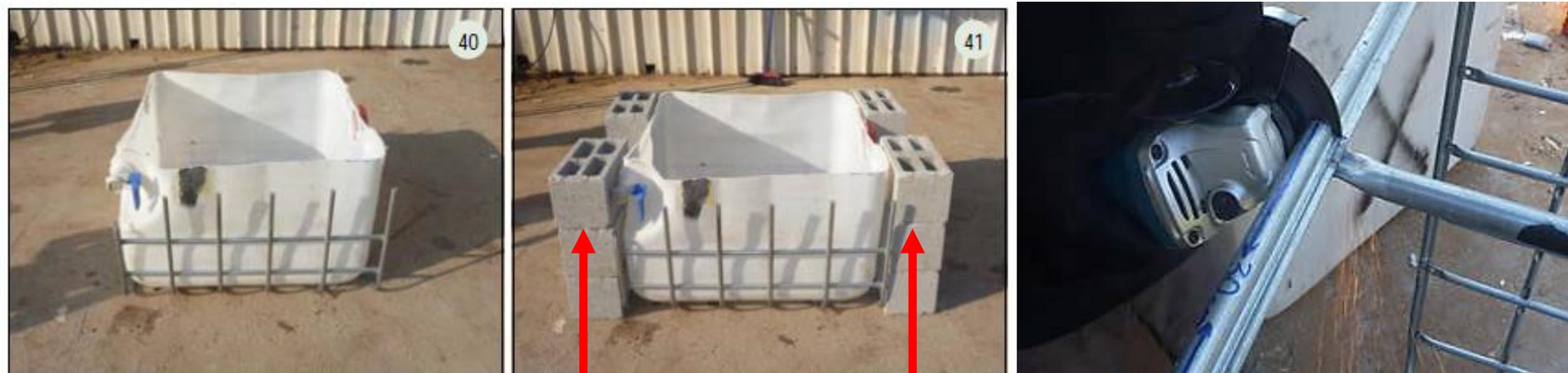
Corta la jaula del IBC según indicado para hacer una cama de cultivo y el tanque sumidero. Hacer un corte limpio y evitar dejar rebarbas (filos) de metal que puedan ser peligrosos.
