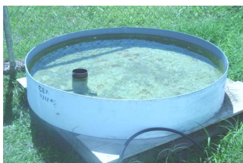
Foto 5. Imagen del Tanque de Evaporación o Evaporímetro.
