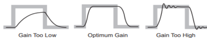
Figura 5.1 Comportamiento de la señal recibida al cambiar el “proportional gain”. Ilustración obtenida del “Controller Service Manual” del MTS.
