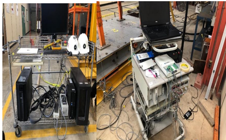
Figura 3.10 Sistema de adquisición y procesamiento de datos (fuente: ExDSRA)
