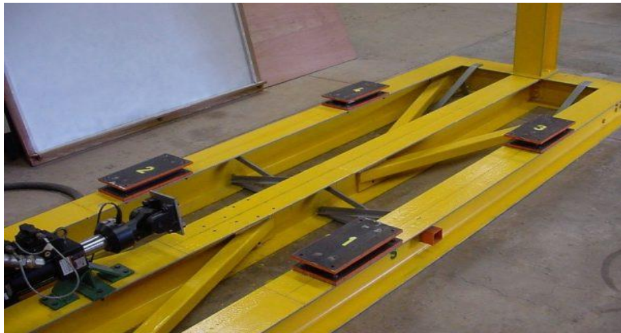
Figura 3.5 Sistema de rodamientos lineales de UPRM frame de la plataforma del simulador (fuente: ExDSRA)
