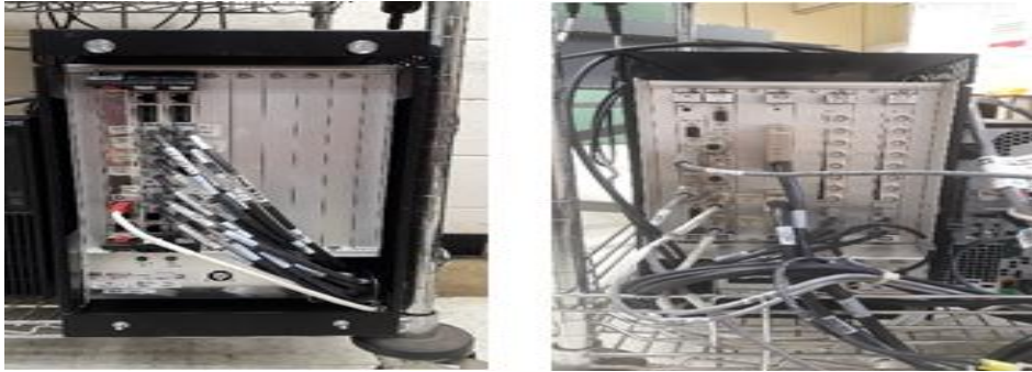
Figura 3.4 Vista frontal (izquierda) y vista trasera (derecha) del servo-controlador (fuente: ExDSRA)
