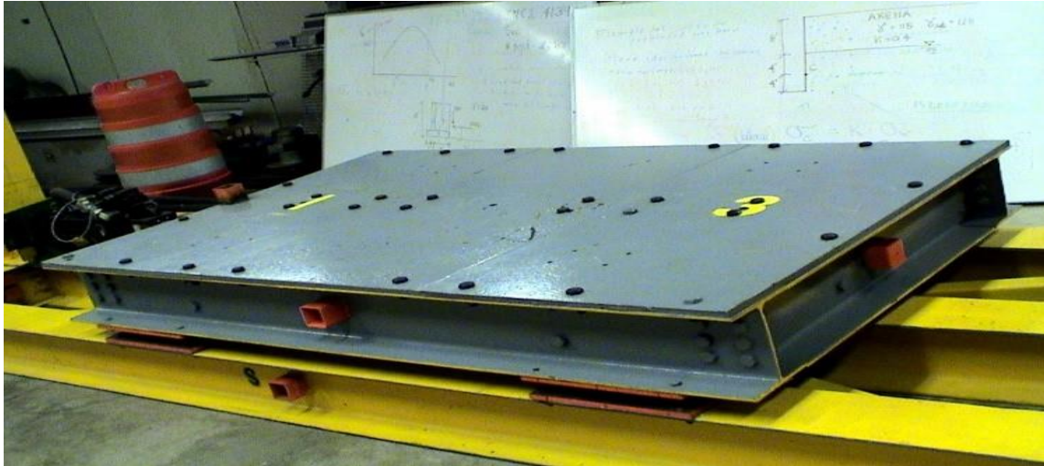
Figura 3.2 Plataforma del simulador con placas de acero atornilladas (fuente: ExDSRA)
