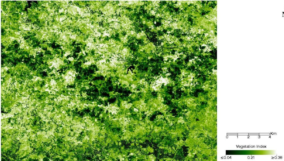
**Figura 9:** Procesamiento de NDVI y aplicación de máscara para obstrucción de valores negativos en imagen del bosque estatal Guilarte, antes del huracán María.
