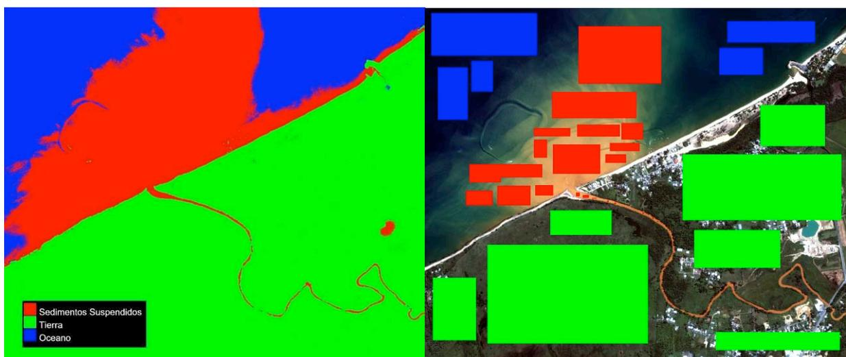
Figura 5. Producto de la clasificación supervisada *Neural Net* de la imagen del Río Culebrinas (izquierda) a partir de regiones de interés definidas por los autores (derecha).
