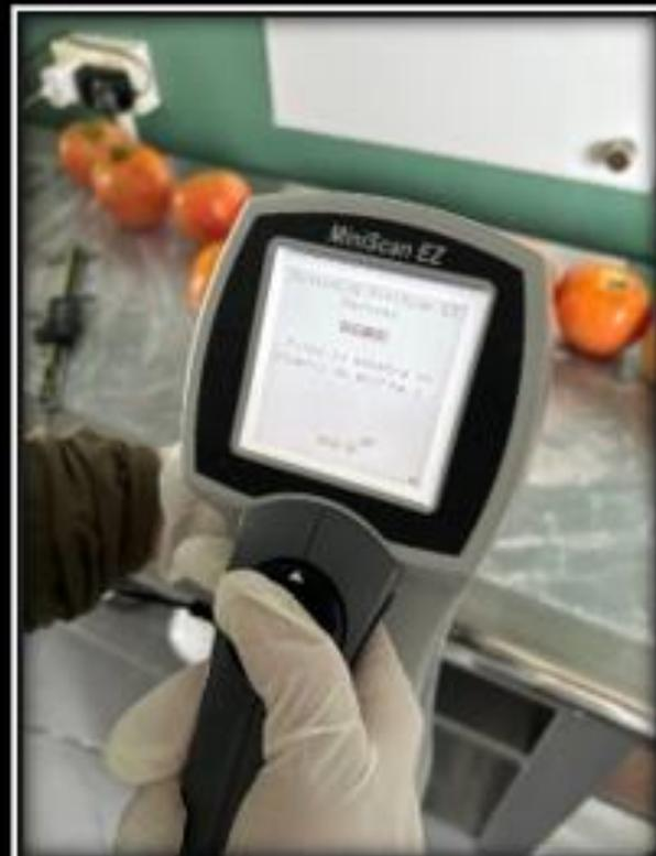
Figura 4: MiniScan EZ 4500 45°/0° geometry portable spectrophotometer. Equipo utilizado para tomar medidas de color (L = brillo, a = coloración rojo y verde, b = coloración amarillo o azulado).
