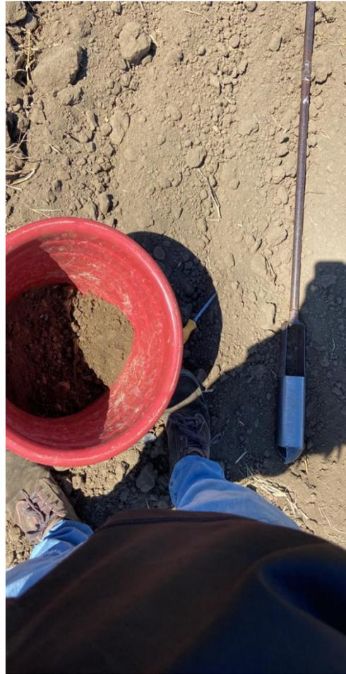
**8 a 10 sub-muestras con auger 6.5 cm dia.**
