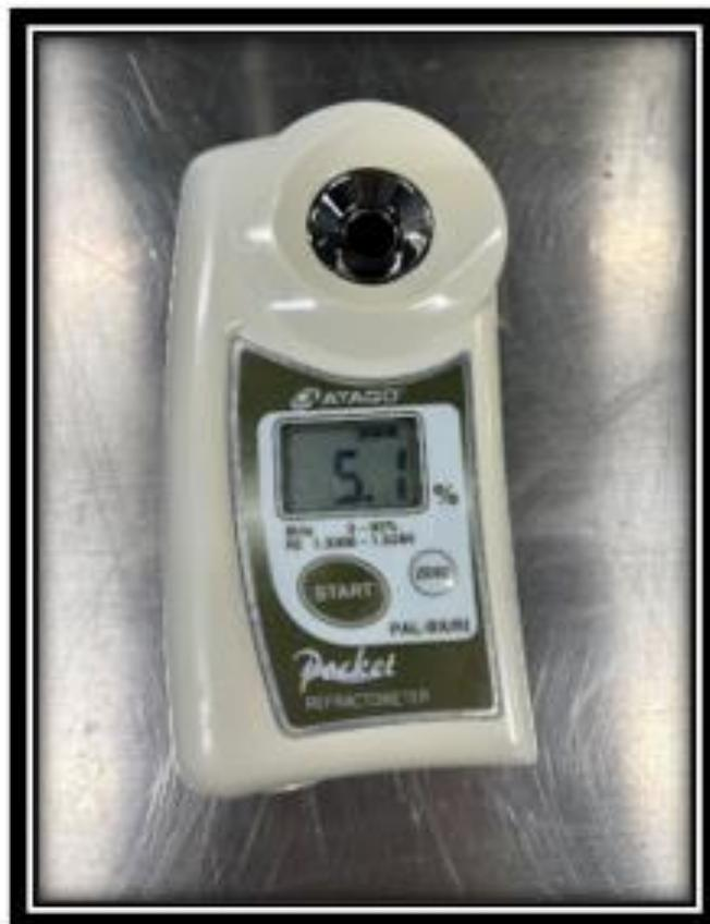
Figura 6: Refractómetro de bolsillo ATAGO, equipo utilizado para medir sólidos solubles.
