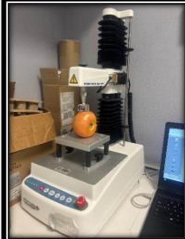
Figura 5: (TA XTplusC Texture Analyser) Texturometro, utilizado para medir parámetros de firmeza.
