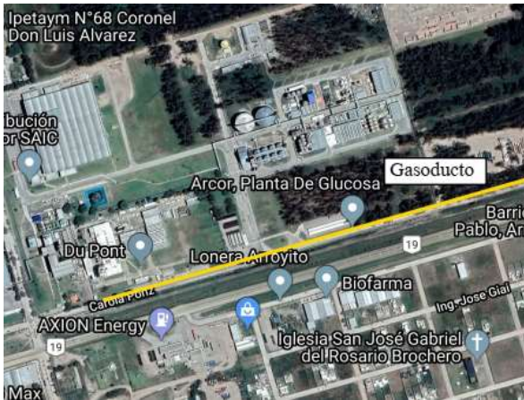
Figura 20: Trazo de gasoducto 6” en Arroyito.
