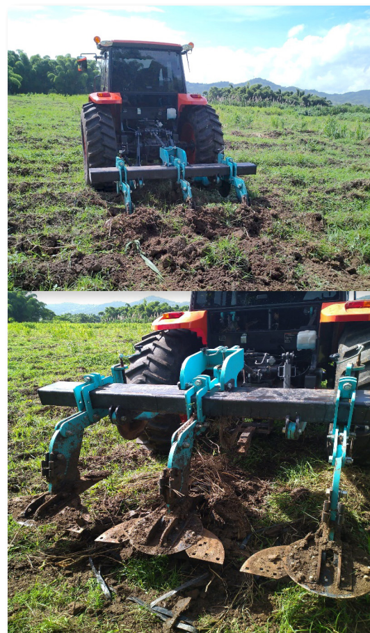
Foto 44. Implemento para arado de conservación. Tomado de Alfredo Aponte, Finca la Zafra en Gurabo, Puerto Rico.
