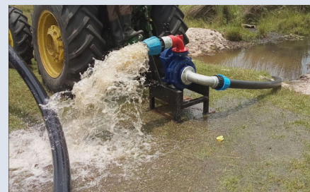
Foto 13. Bombas de engranaje de PTO. Tomado de Weis Engineering Ltd, Uganda, África.
