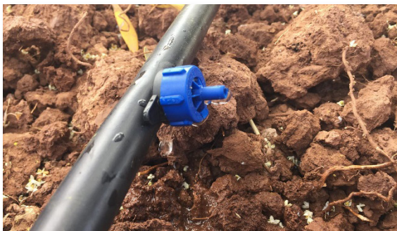
Foto 34. Líneas de distribución de riego con emisor externo. Tomado de MIT Gear Lab, Cambridge MA, Estado Unidos.
