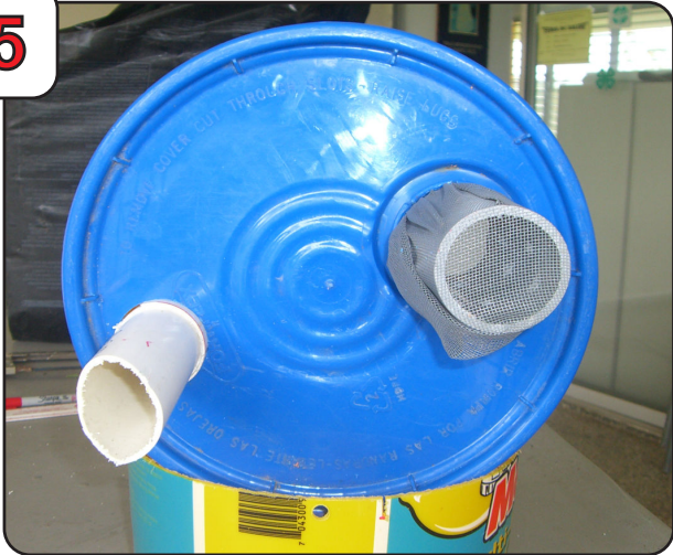
Vista de la tapa que servirá de parrilla por debajo. Esta parte va en el interior de la reserva de agua.
