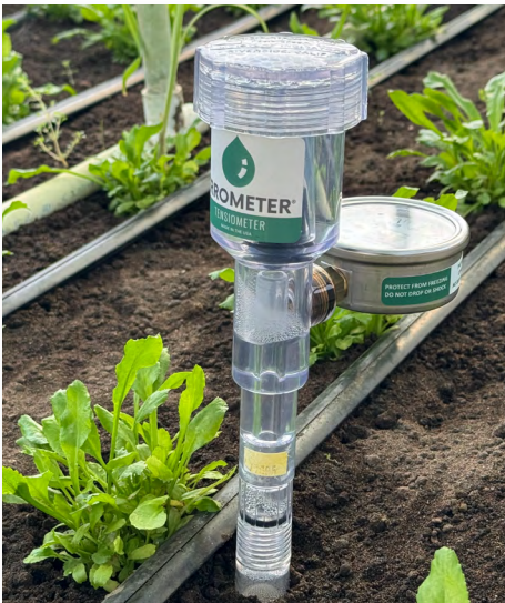
Figura 16. Tensiómetro. Instrumento utilizado para medir la disponibilidad de agua en el suelo. Foto por Filiberto Troche.
