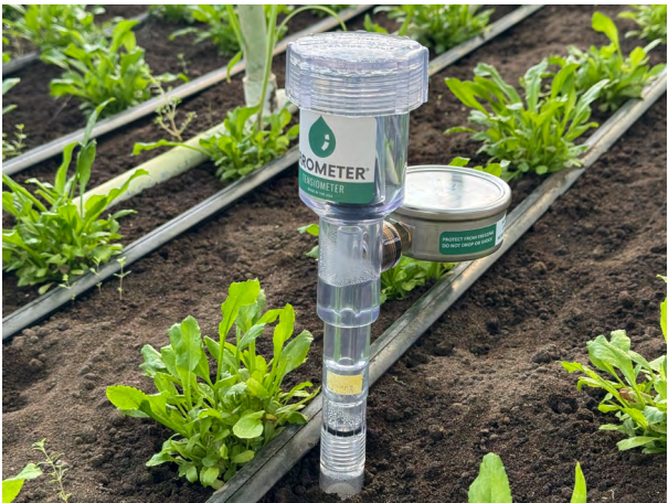
Figura 7. Tensiómetro utilizado para medir la disponibilidad de agua en el suelo. Foto por Filiberto Troche.
